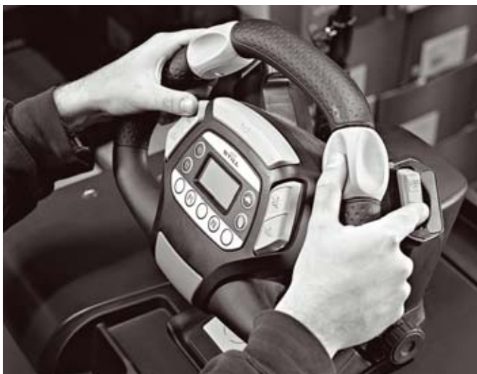
Unik STILL Easy Drive-ratt som ger en optimal körkänsla och gör att du kan manövrera alla funktioner utan att behöva flytta händerna
