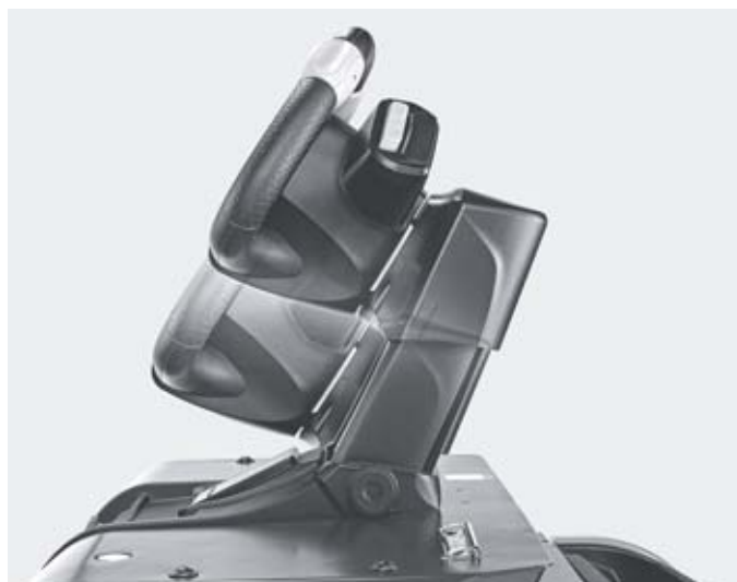
Högsta ergonomi tack vare ratten som kan justeras i höjdlöd och vinklas lätt för att passa olika förarens önskemål
